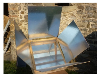
Réflecteurs en position de chauffe
